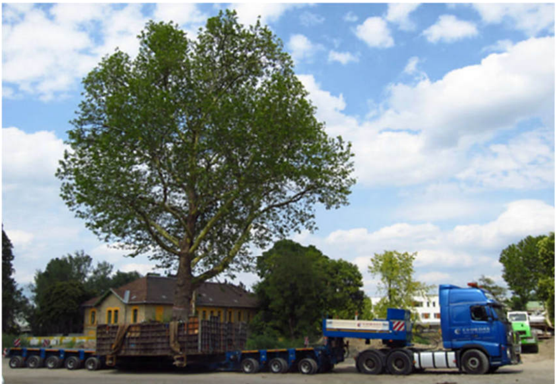
Abbildung 24: Transport eines Größtbaumes mit einem Schwerlasttieflader
